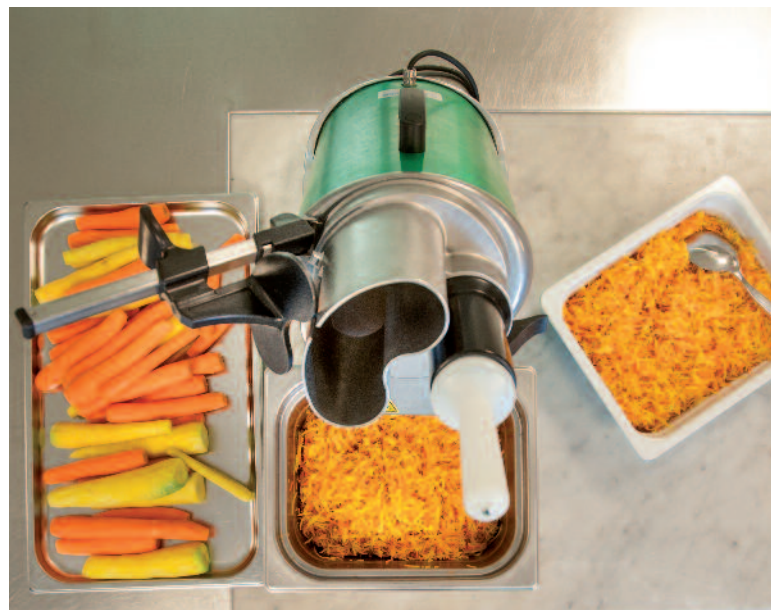
Dank ihrem «ziehenden Schnitt», einer sanften, dem manuellen Schneiden nachempfundenen Technik, überzeugt die «Anliker» seit 50 Jahren Küchenchefs im In- und Ausland – und dies auch im Jahr 2015 ohne Elektronik!
